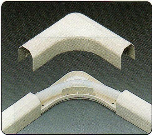
くするための商品も幾つかのメーカーが販売しています。その一つが「配管モジュール」。「リフォーム・ダクト」と呼ばれる配管カバーです。HTVP、VP、樹脂管などを中に通すことができます。カバーとベースが分割できるので、メンテナンスも容易におこなえるように出来ています。
