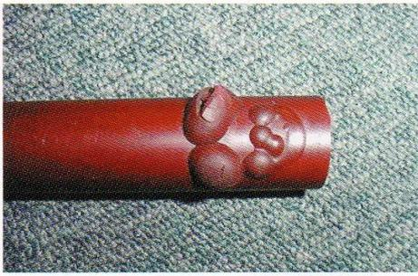
な硬質塩化ビニル管に可塑剤を含んだ支持バンドやパッキンなどが付着すると、写真のような軟化や亀裂を生じることがあるのです。
