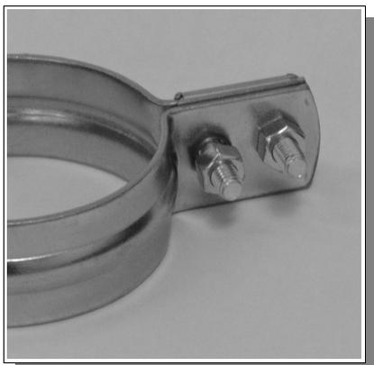
★立管バンドの締付けボルトの径と長さは、15A～50AまではM6×20、65A～100Aは、M8
