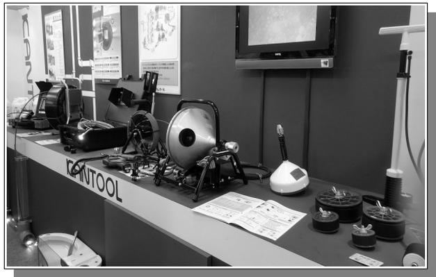
ワイヤー式排水管掃除機の他に排水管用止水プラグや公共下水用のムニ
