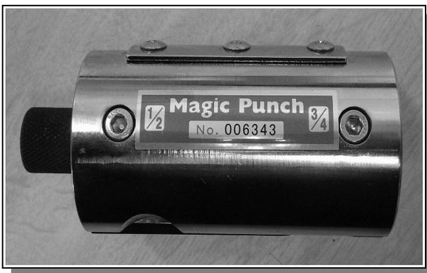
ハンマー式のフレキツバ出し工具です。1/2と3/4サイズのフリーチューブのつば出し加工が行えます。メーカーはユタカ産商株式会社。
