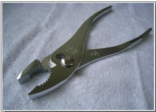
ちょっとした。ネジやボルト・ナットなどを回します。正式名称は「コンビネーションプライヤー」根本がニツパーになっているので針金程度のものなら切断可能です。またジョイント部分がスライド構造になっているので、通常のペンチよりも挟める範囲が広いので、自動車の車載工具によく採用されています。人によっては「やっこ」といわれます。
