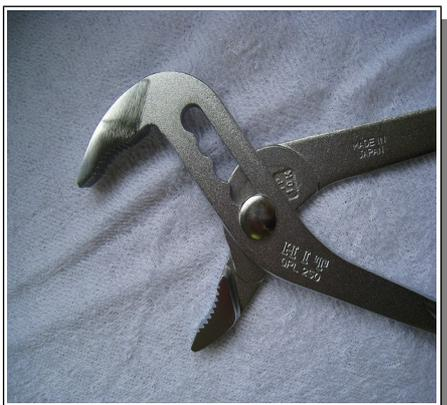
ジョイント部分が大きくスライドするようになっています。取っ手の部分が平たくなっていますので、ドライバースト水栓の開閉にも使えます。水栓金具のメンテナンス現場に持って行くと便利です。別名「アンギラス」とも言います。
