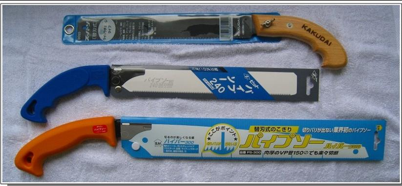
上からカクダイのスーパーソー（塩ビパイプ・鋼管・真鍮管・アルミ・新建材など）、岡田金属工業所のパイプソー240サイズ（塩ビパイプ・一般木材・プラスチックなど）とハウスBMのパイプソー・ハイパー300（塩ビパイプ・プラスチック・サイディング・一般木材など）になります。
