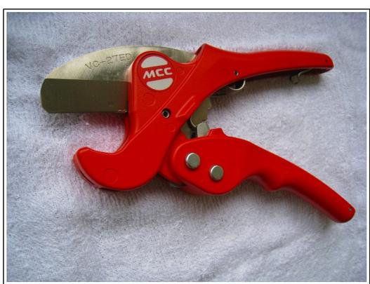
小口径の塩ビパイプを押し切るための工具です。テコの原理を利用して素早く切断ができます。20Aまでカットできる27タイプと32Aまでカットできる42タイプがあります。
