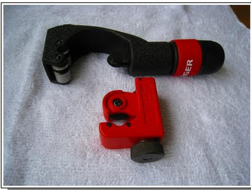
銅管や給水用ヘリユース管などを素早く切断します。回しながら押し切るので仕上がりがきれい。流し台下などの狭い場所でも回せるミニタイプもあります。
