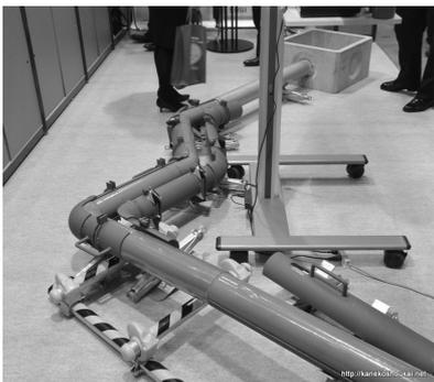
形状記憶性を持つ、だ円状の硬質塩ビ管に高温の蒸気を通して加熱し、円形に復元します。復元された管を排水管の中に通し、圧縮空気により管の内側に密着させて、排水管内部に形状記憶型硬質塩ビ管を形成する工法です。下関でもマンションなどの集
