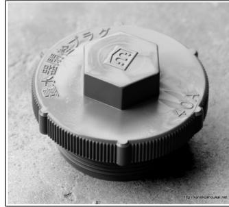
上水ネジタイプ（青）を在庫しています。面間寸法に関係なく完全閉栓します。材質は塩化ビニールです。サイズは、13,20,25,40の4タイプを揃えています。
