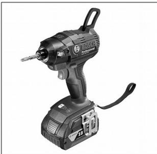
トルク調整はできません、正転逆転、トリガーによる回転調整ができます。6.35mmの六角軸ビットをワンタッチで抜き差しするロックリング方式のものが多くあります。インパクトドライバーもネジ締めに特化しているため、
