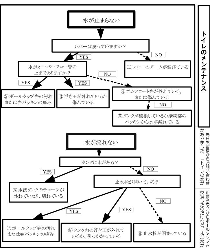
それぞれの解決方法を試してみ 止まらない原因はボールタップよく聞いてみると、実は水が 止まらない」とのこと。 ましょう。 に九つの原因を表してみました。 とが可能です。上のチャート図 ルは素人でも自分で解決するこ 解できていれば、 化が原因でした。 ではなく、 ロータンクの構造はわりと単 水の流れる仕組みさえ理 ゴムフロート弁の劣 多くのトラブ
