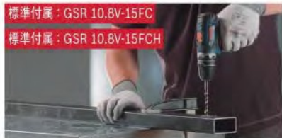
キーレスチャックアダプター装着時の作業例
