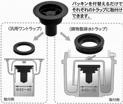
ワントラップの排水口を大幅に緩切れによる臭い漏れを大幅に緩和します。排水口のトラップに緩切れを緩切れに対応しています。
