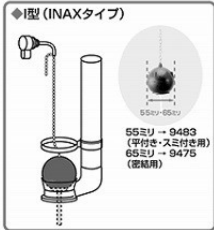
I型のゴムフロートは、平付き・スミ付き用、密結専用の2種類があります。
