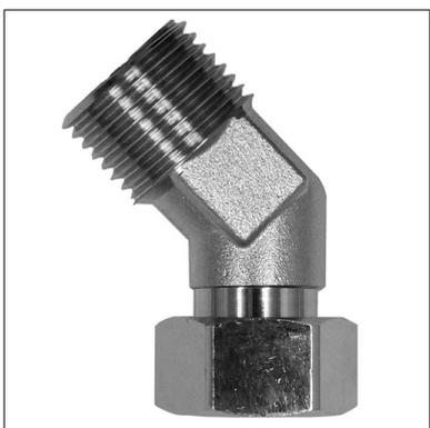
止水栓回りの配管の角度調整に最適な継手。止水栓と混合栓のフレッドホースの間に使うことでホースの座屈を防止し水漏れリスクを低減します。本体は黄銅製クロームメッキゴム
