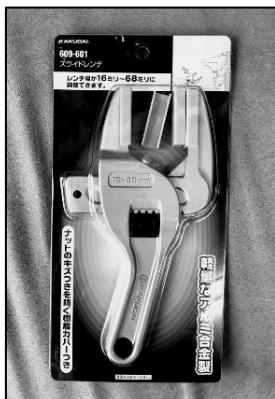
レンチ幅が16ミリ～68ミリに調整できます。軽量なアルミ合金製。ナットの傷つきを防ぐ樹脂カバー付トラップ管などの装飾衛生配管の各種ナット部に使用できるレンチです。
