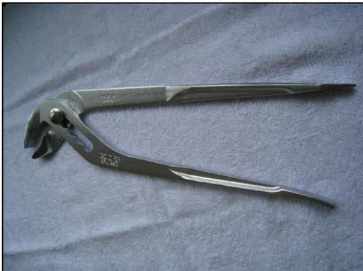
ジョイント部分が大きくスライドするようになっています。取っ手の部分が平たくなっていますので、ドライバー式止水栓の開閉にも使えます。水栓金具のメンテナンス
