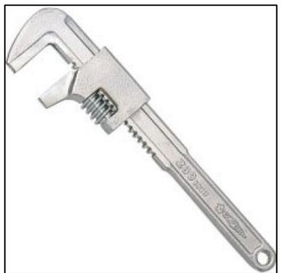
ヤスタブルなレンチです。排水パイプのジョイント部の袋ナットの締め付けなどに重宝します。
