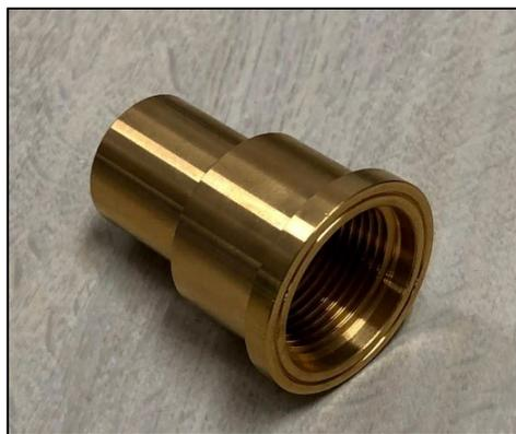
鉛管の補修に使用します。鉛配管はH I V Pなどにすべて引き換えするのが推奨されていますが、さまざまな理由で鉛管をそのまま生かして配管する場合があります。オスアダプター（バルブソケット）などと組み合わせて管種を変換するときにご利用ください。
