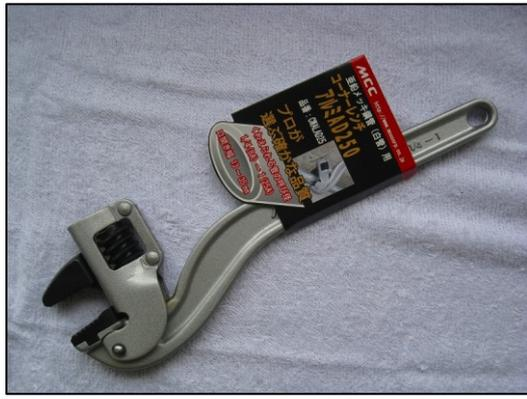
ボックスの中にある配管継手を回すときには必須ですね。取り回しの楽なアルミ製の物が人気があります。
