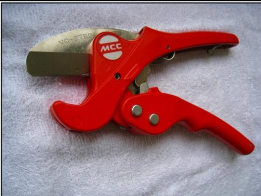
小口径の塩ビパイプを押し切るための工具です。テコの原理を利用して素早い切断ができます。20Aまでカット
