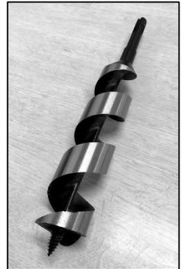
軽量ハンマードリルにワンタッチで装着できるSDSプラスシャンクの木工用ドリルです。20Aの管が通る32サイズを在庫しています。
